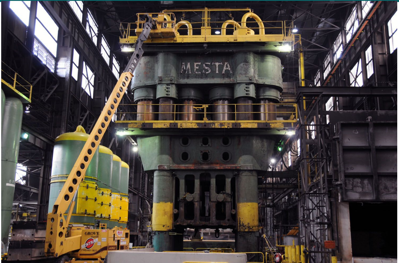
Umformmaschiene – mit 500.000 KN Umformungskraft
